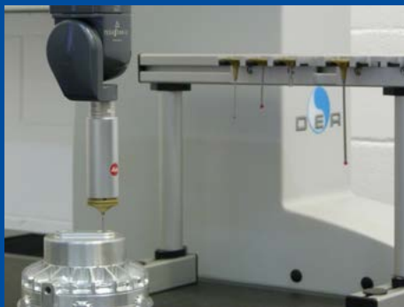
Machine de mesure par coordonnées (MMC) DEA GLOBAL PERFORMANCE 9128 équipée d'une tête TESASTAR-M et d'une sonde de mesure en continue LEITZ LSP-X1
